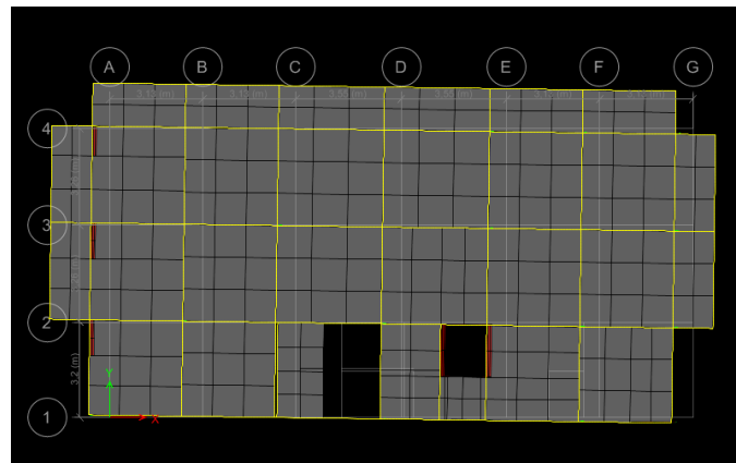
Figure IV-5: Deuxième mode de déformation (translation suivant X) (T=0,59sec)
