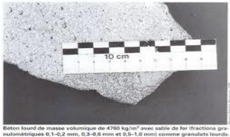
**Figure II.3:** Béton lourd de masse volumique de  $4760 \text{ kg/m}^3$  avec sable de fer (fractions Granulométriques  $0,1-0,2 \text{ mm}$ ,  $0,3-0,6 \text{ mm}$  et  $0,5-1,0 \text{ mm}$ ) comme granulats lourds. [42]
