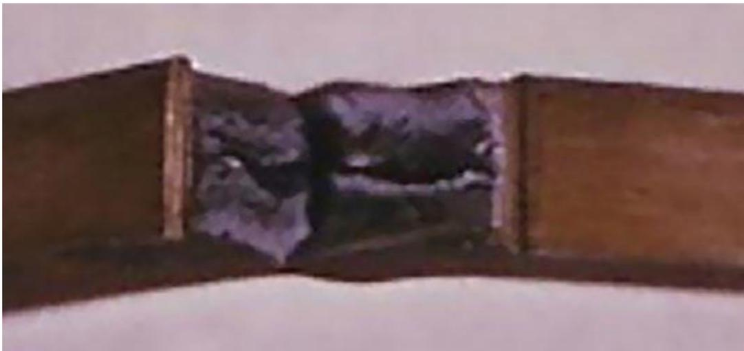
*Figure 3-4: Porosité dans la masse d'un acier des années 1970*
