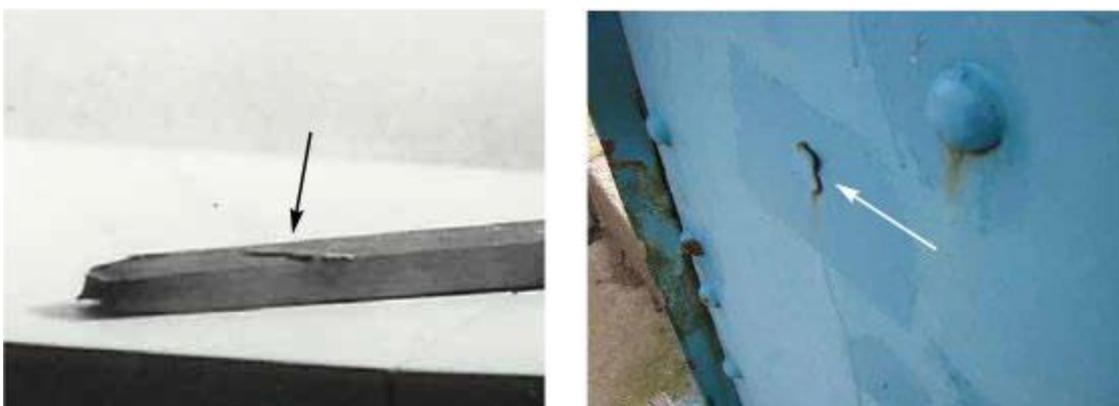
*Figure 3-6:Pailles sur éprouvette d'essai et sur ouvrage*
