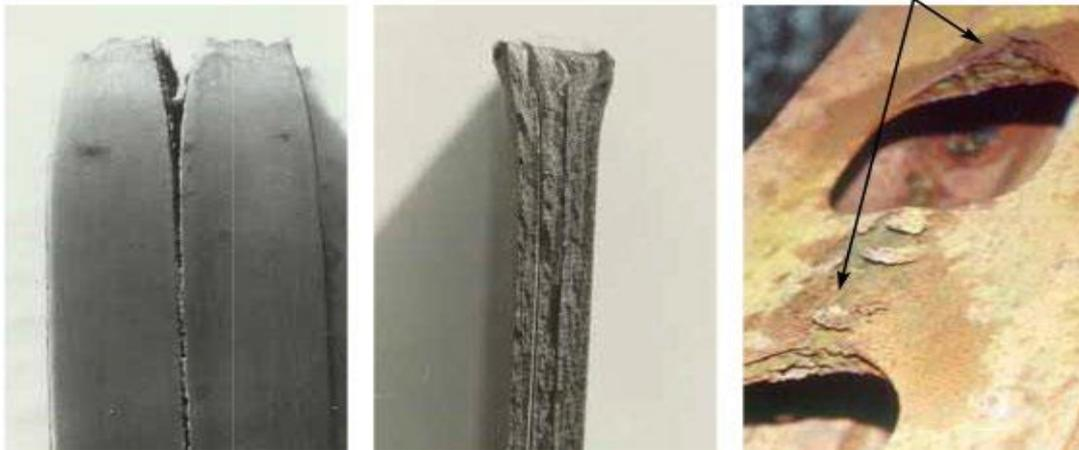
Eprouvette de traction dédoublée - dédoublure multiple sur un large plat
