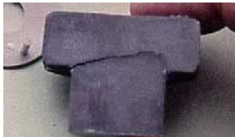
Figure 3-31: Coupe d'un boulon HR galvanisé rompu par fragilisation par l'hydrogène.
