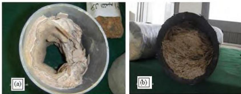
Figure A.II.1 : Photos des dépôts de tartre de carbonate de calcium dans la canalisation [16]
