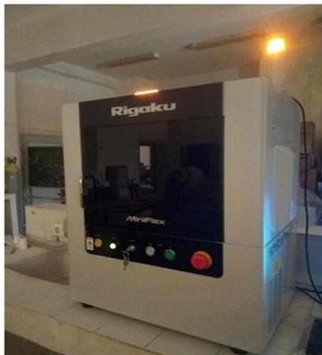
**Figure B.VII.1** : Diffractomètre a rayon X de type Rigaky (MiniFlex) [151]
