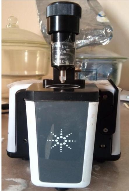
**Figure B.VII.2** : Spectromètre IR à transformée de Fourier (CARY) [151]
