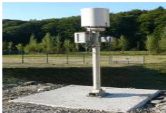
Figure I.10 : Un pluviomètre à augets électronique [20].
