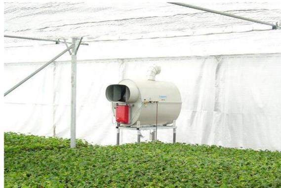
Figure I.6 : Un chauffage d'air [17].
