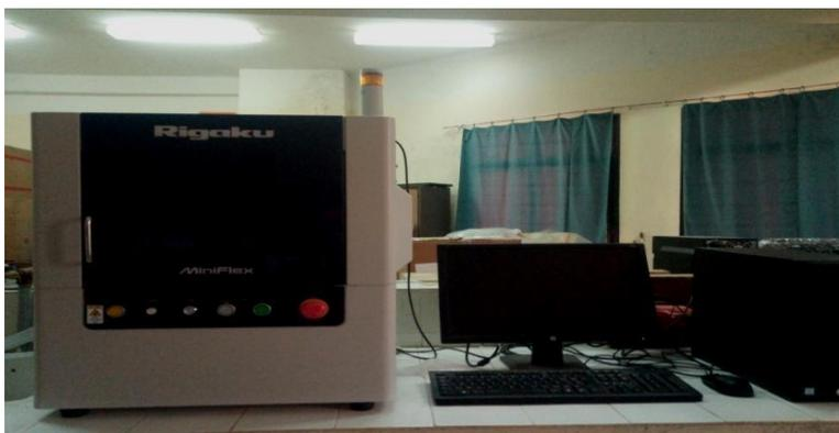
Figure III.2 : Diffractomètre Rigaku [4].
