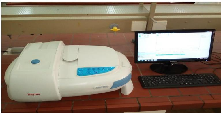
*Figure III.1: Spectrophotomètre d'absorption UV-visible (EVOLUTION 201) [4].*
