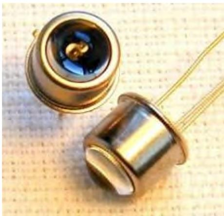
*Figure II.9 : photodiode [65]*
