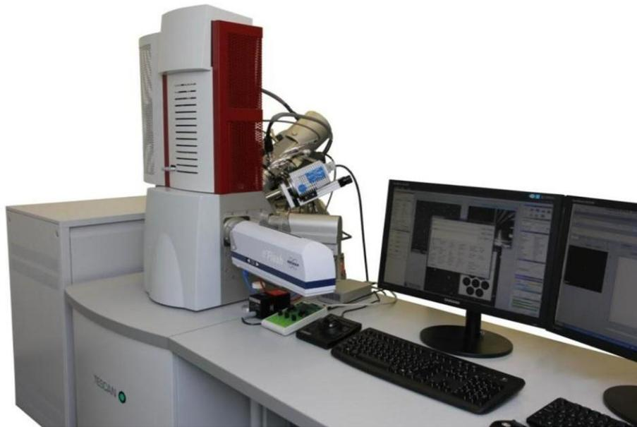
**Figure III.3 :** Schéma d'une microscopie électronique à balayage.
