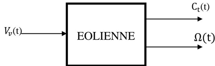
**Figure II.2:** Entrées – sorties du modèle de la voileur éolienne.
