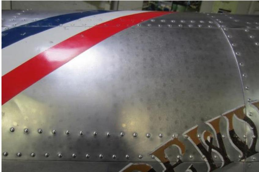
Figure IV. 1 Ligne de rivet sur fuselage d'avion
