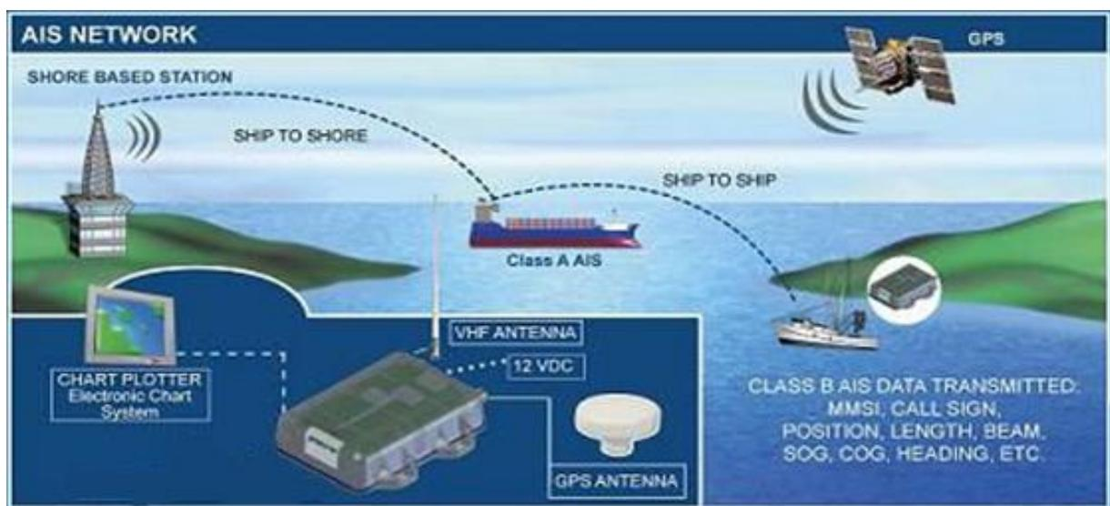
Figure I.3: Déroulement de la communication par AIS.
