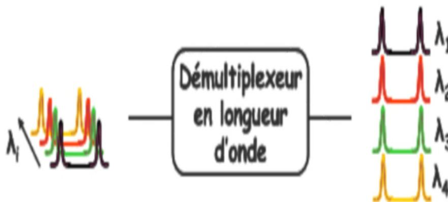
**Figure II:13** : Schéma du principe de fonctionnement d'un démultiplexeur [38].
