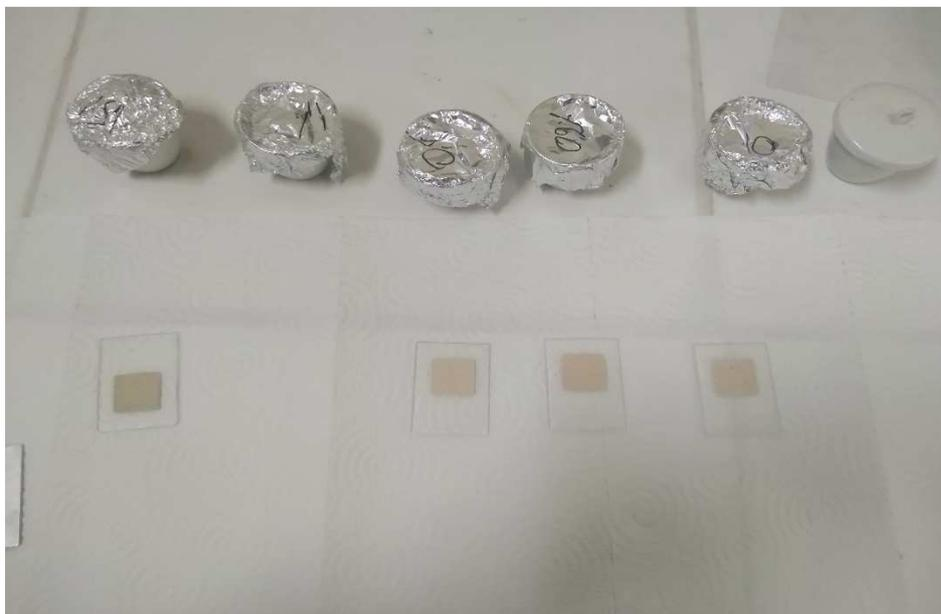
**Figure III-1** : Séchage des poudres des nano-composites sur des lames de verre.
