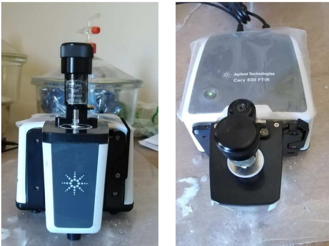
Figure II-11 : Photographie du spectromètre FTIR utilisé.
