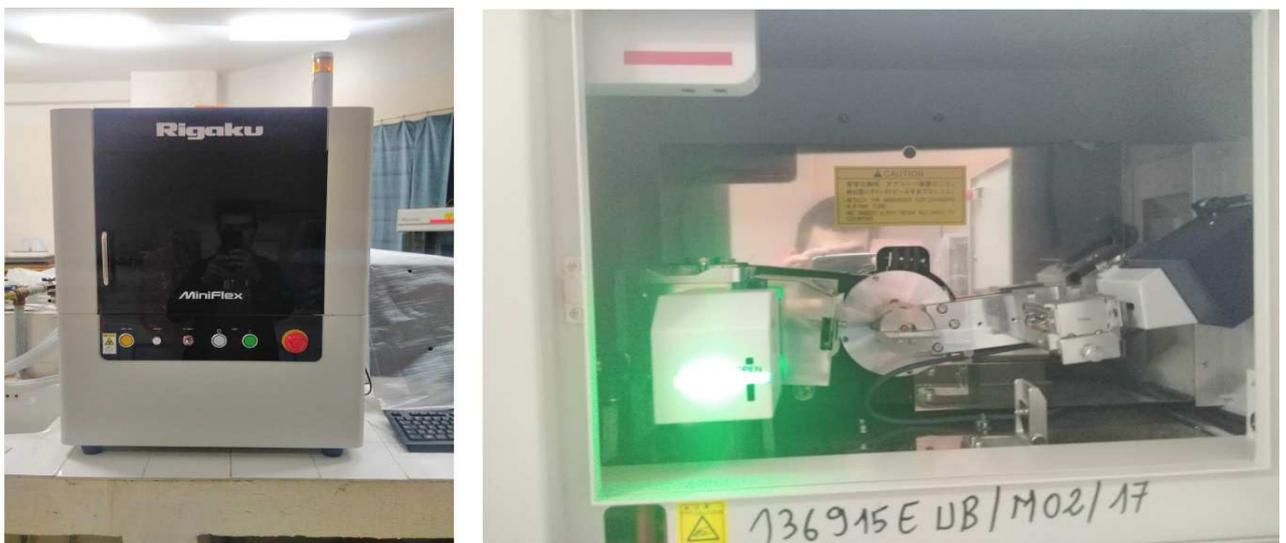
**Figure II-8:** Photographie du diffractomètre utilisé.
