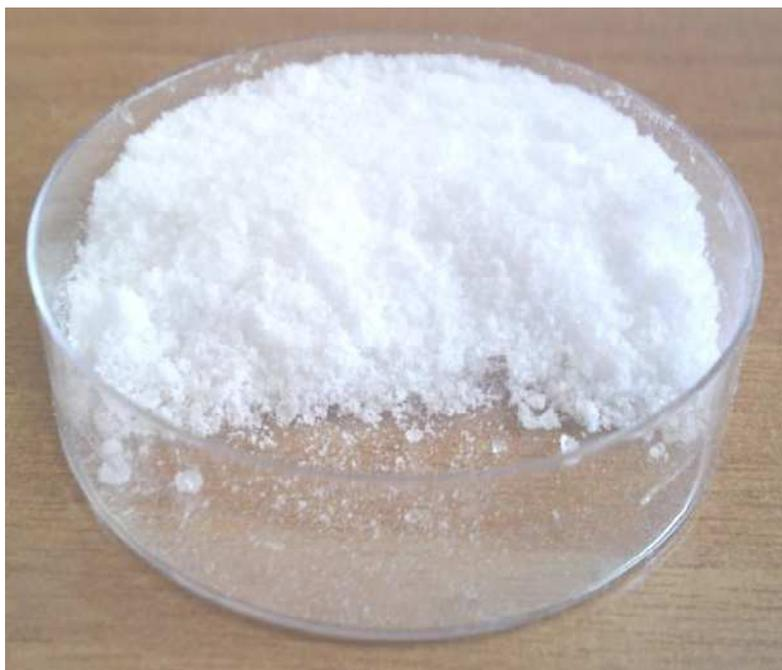
**Figure II-4 :** Photographie de la poudre obtenue après le séchage et le broyage.
