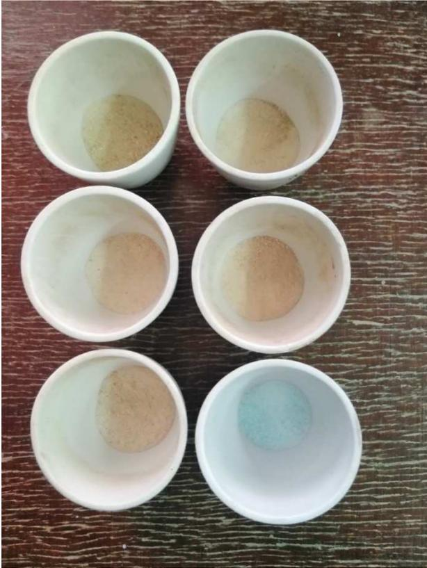
**Figure II-6:** Photographie des poudres obtenues après le traitement thermique.
