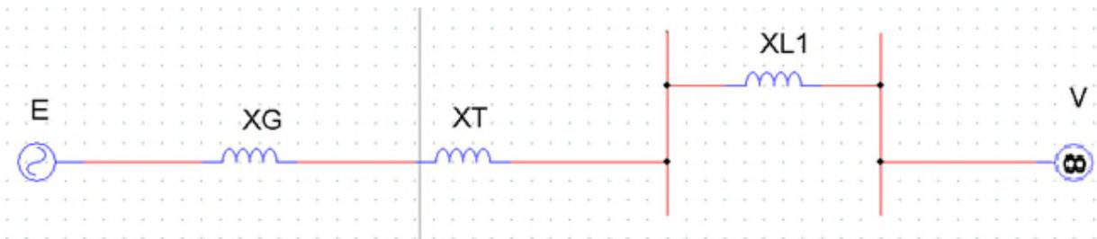
*Figure IV. 6 : Schéma du système de puissance après le défaut.*
