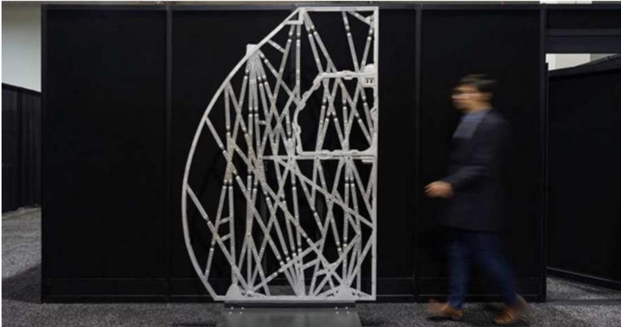
**Figure I.7** La cloison Airbus plus légère et plus solide Avec l’aimable autorisation d’Airbus
