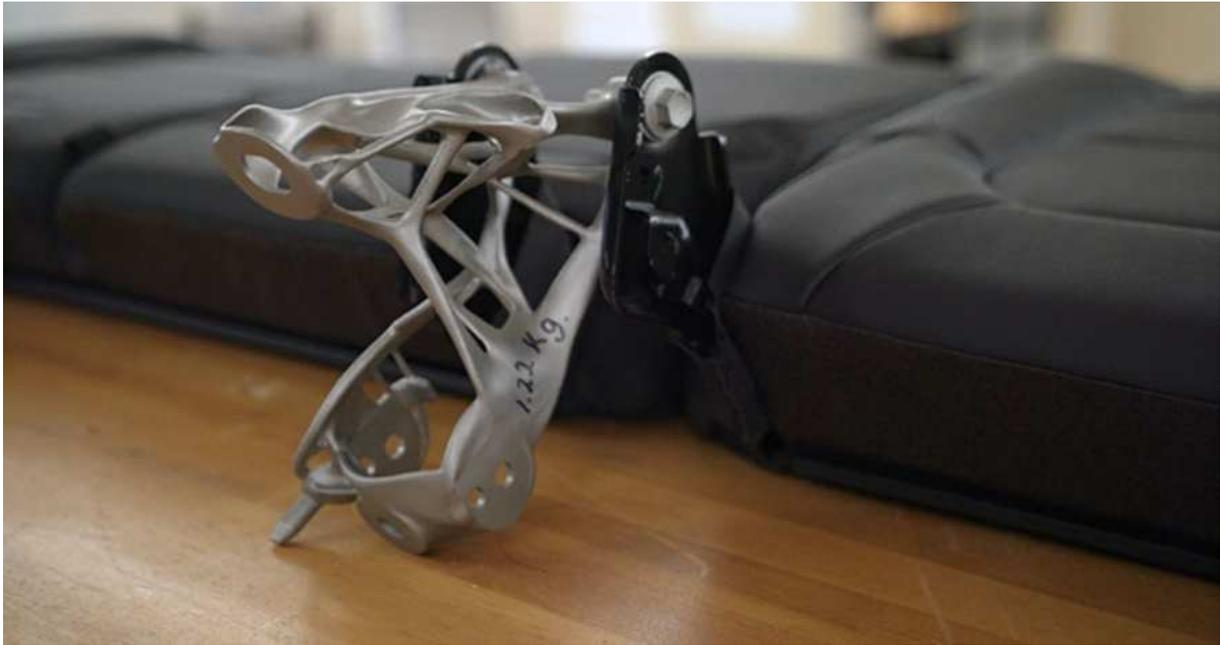
**Figure I.6** La fixation pour les ceintures de sécurité repensée de général Motors Avec l'aimable autorisation de General Motors
