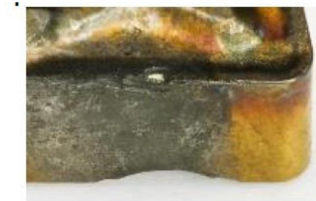
**Figure I.13 .** Usure par écaillage en dehors de la zone de coupe [5] .
