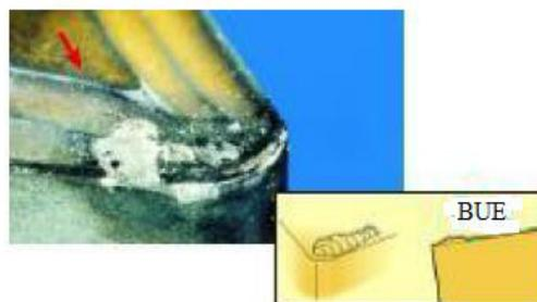
**Figure. I .12** Usure par l'arête rapportée ou copeau adhérent [5].
