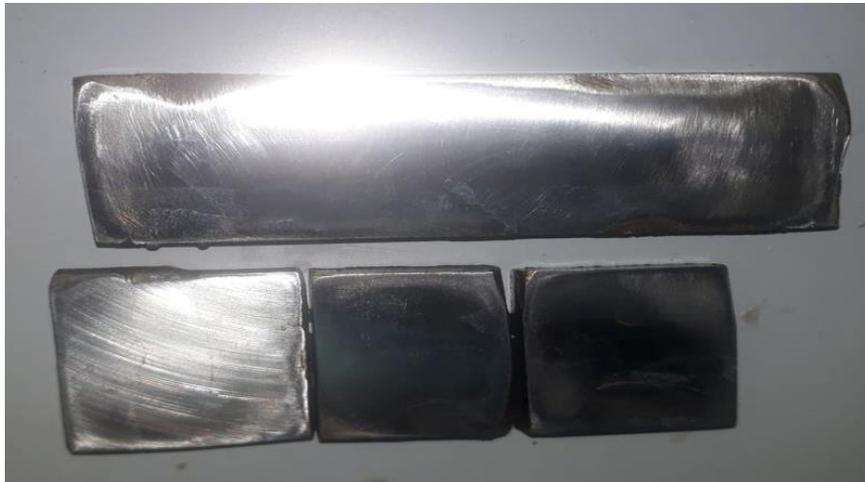
Figure III.2 : Les surfaces des plaquettes soudées après le polissage.
