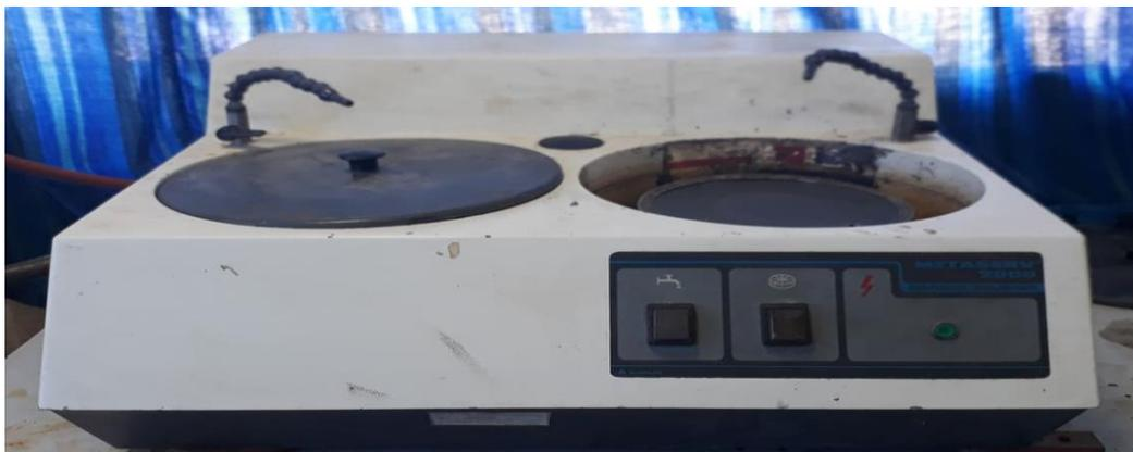
Figure.III.3 : Polisseuse a double plateaux
