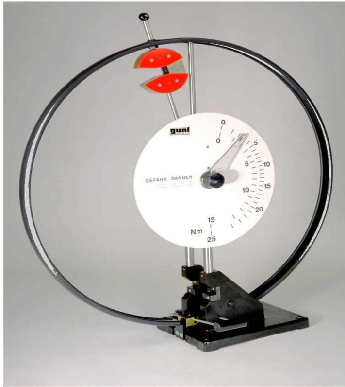
Figure III.5: Machine de résilience MT 3016.
