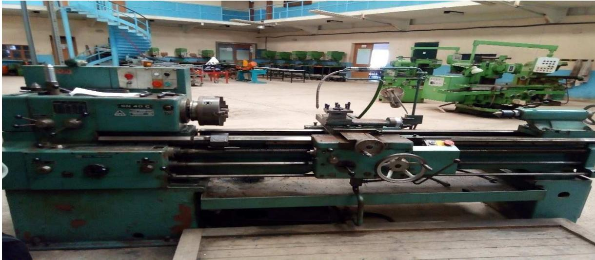
Figure III.2 Tour conventionnel type SN 40 C du hall de technologie université de Bejaia.
