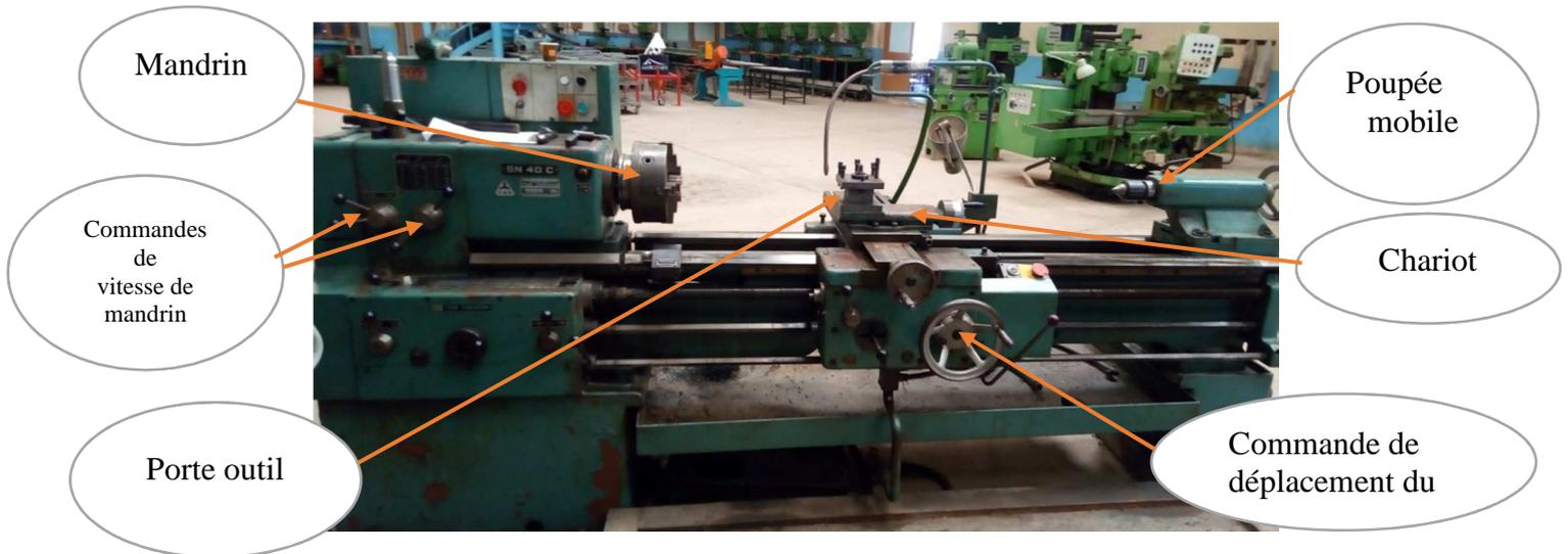
**Figure I.4.** Tour conventionnelle type SN 40 C du hall de technologie.
