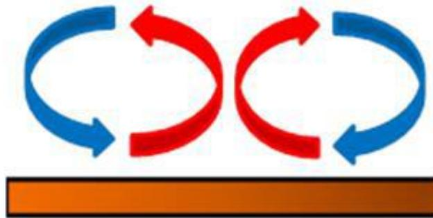
**Figure I-4 :** Schéma représentatif de la convection naturelle
