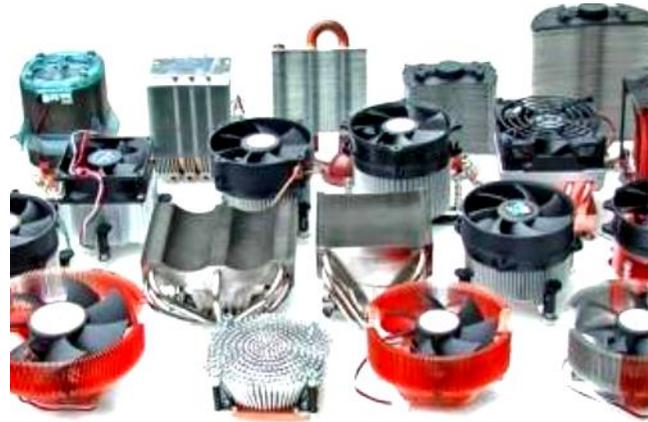
Figure I.3: Exemples de systèmes de refroidissement à air pulsé
