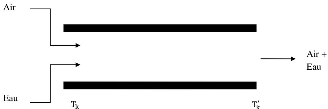
FigureII.2 : mélange adiabatique et isobare des flux d'air et d'eau dans le canal d'admission
