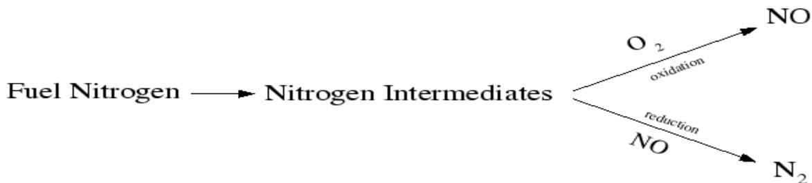
En outre, La formation de NO dans les combustibles dépend très faiblement de la température, contrairement au NO formation liée à l'azote atmosphérique
