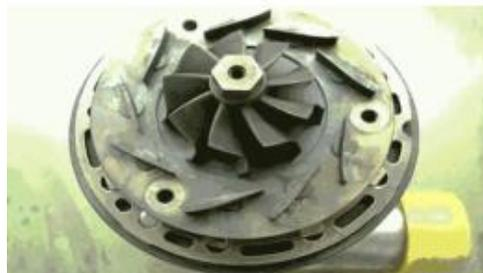
**Figure II.5 :** Turbocompresseur à géométrie variable [12]
