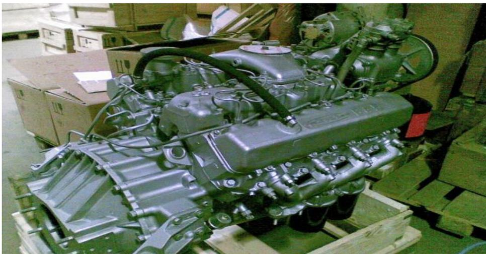
**Figure III.1 :** Moteur Diesel (ZIL-645) [9]
