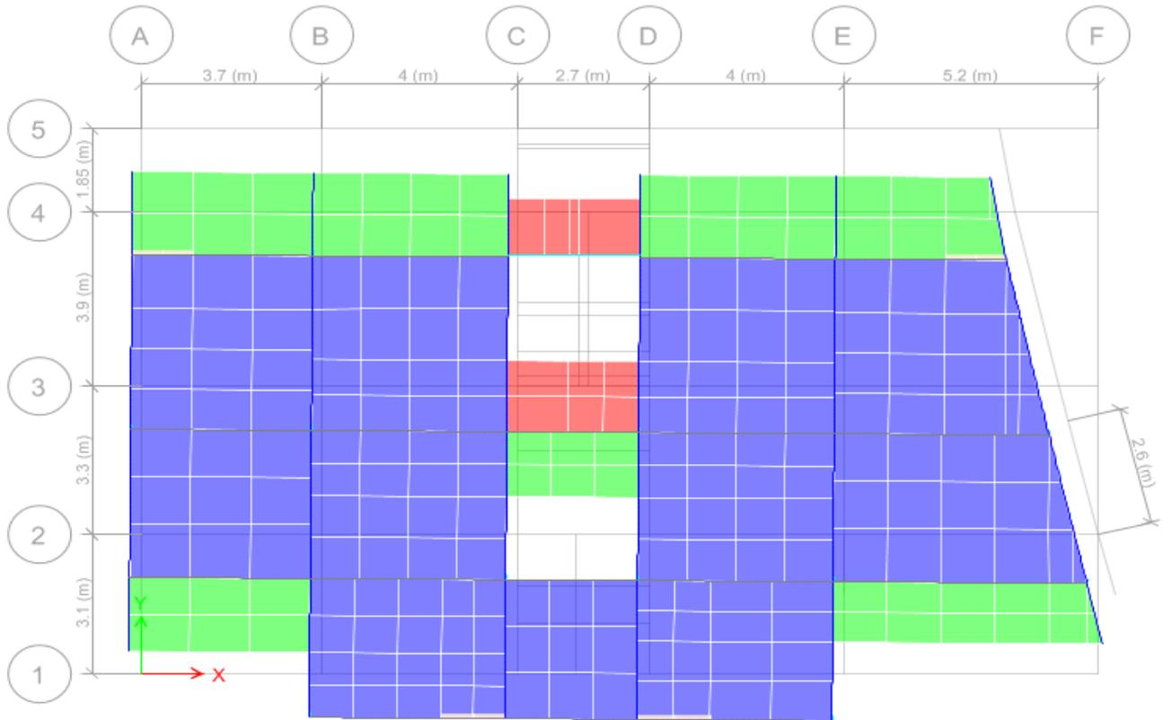
Figure 04.5. 1<sup>er</sup> mode de vibration T= 0.99 s.
