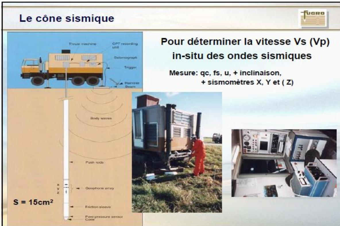
Figure 18 : Mode opératoire du cône sismique[1].
