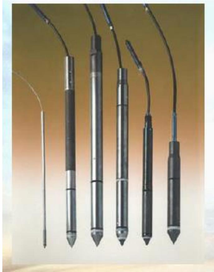
**Figure 14 :** Les différentes tiges du cône électrique[1].
