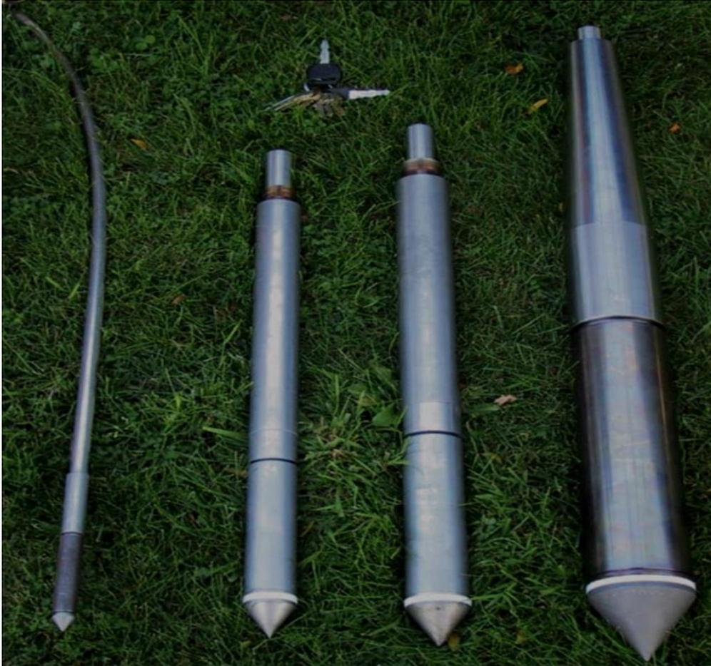
**Figure 2 :** Gamme de sondes CPT (2cm , 10 cm , 15cm , 40cm ) [27].
