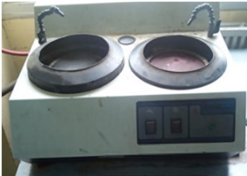
**Figure III.7.** Photo d'une polisseuse METASERV 2000.
