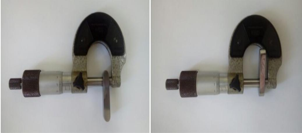
**Figure III.8.** Photo d'un palmer.
