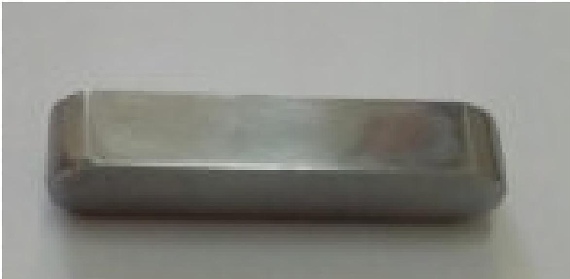
**Figure III.9.** Pièce final (la clavette parallèle).
