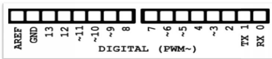
Figure II.16: Entrées et sorties numériques.
