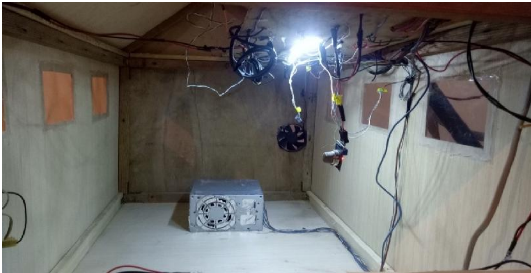
(b) Les lampes s'allument, en exposant le capteur de luminosité LDR à l'obscurité.
