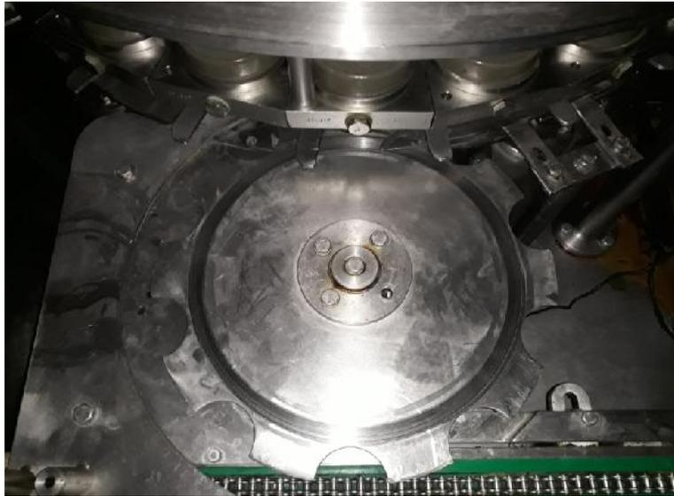
Figure II.5: plateau transporteur de la remplisseuse
