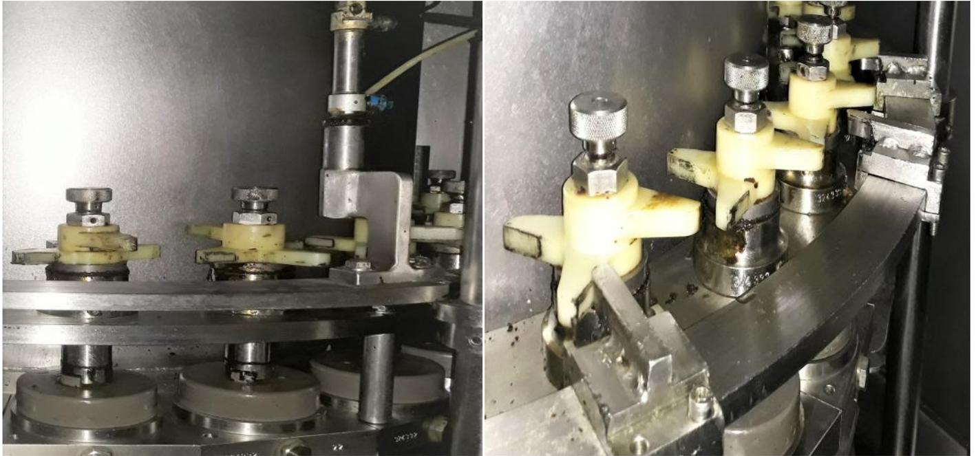
Figure II.8 : doseur de la tourelle de remplissage
