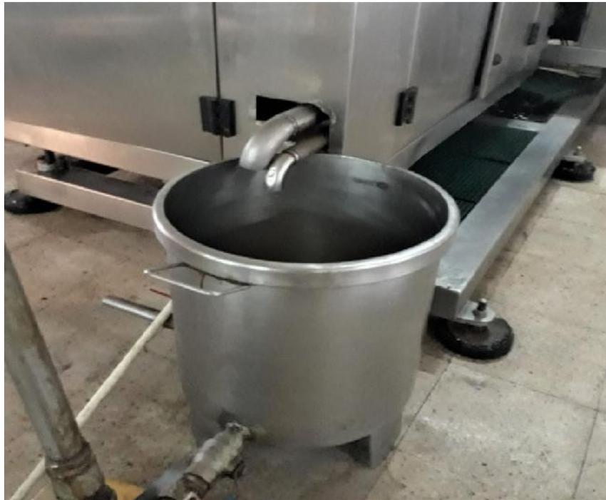
Figure II.10 : réservoir de recyclage du produit
