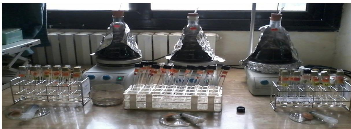
**Figure II.3.** Dispositif expérimental utilisé pour les tests d'adsorption.
