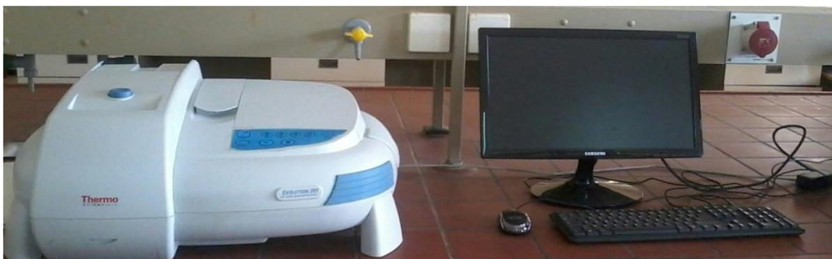
**Figure II.1** : Le spectrophotomètre UV-visible utilisé pour mesurer les absorbances des solutions préparées.
