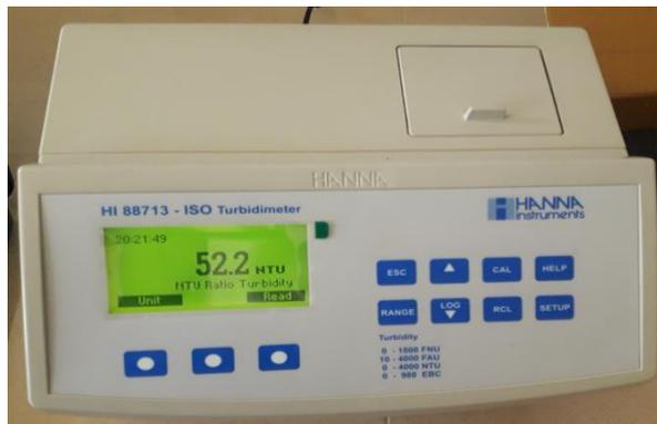
**Figure 20 :** Photo du turbidimètre de type HANNA 88713 (Belkhiar, 2019).
