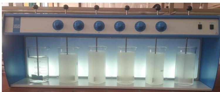
Figure 17 : photo d'un dispositif Jar-Test (Belkhiar, 2019).
