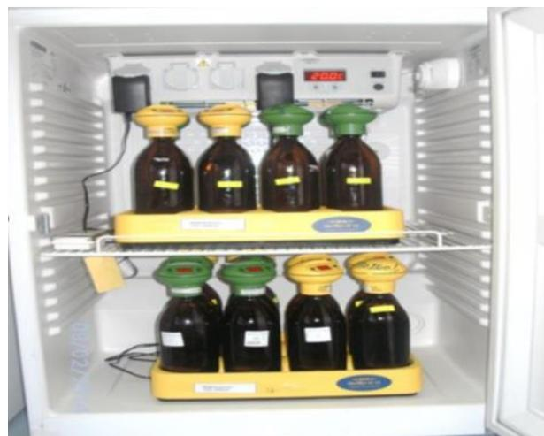
**Figure 26** : DBO mètre de type OxiTop® IS12 (Belkhiar, 2019).
