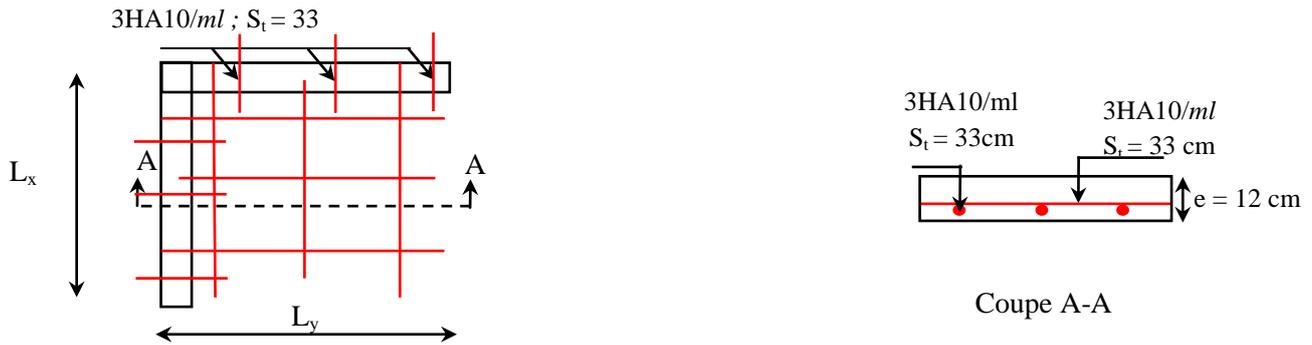
Figure. II.17. Schéma de ferrailage de la dalle D4
