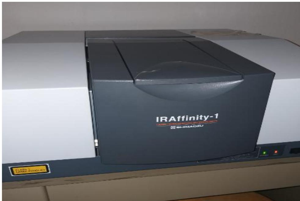
**Figure I.7:** Spectromètre Infrarouge à Transformée de Fourier.
