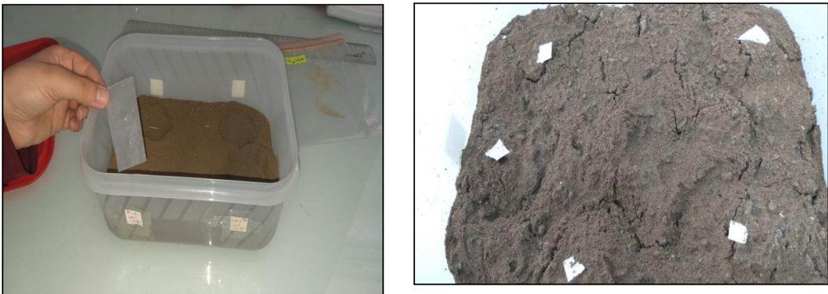
**Figure I.10:** photos illustrant le test de la biodégradation dans le sol.
