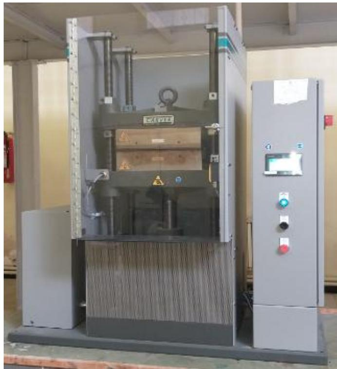
**Figure I.6:** Presse hydraulique utilisée pour la préparation des films
