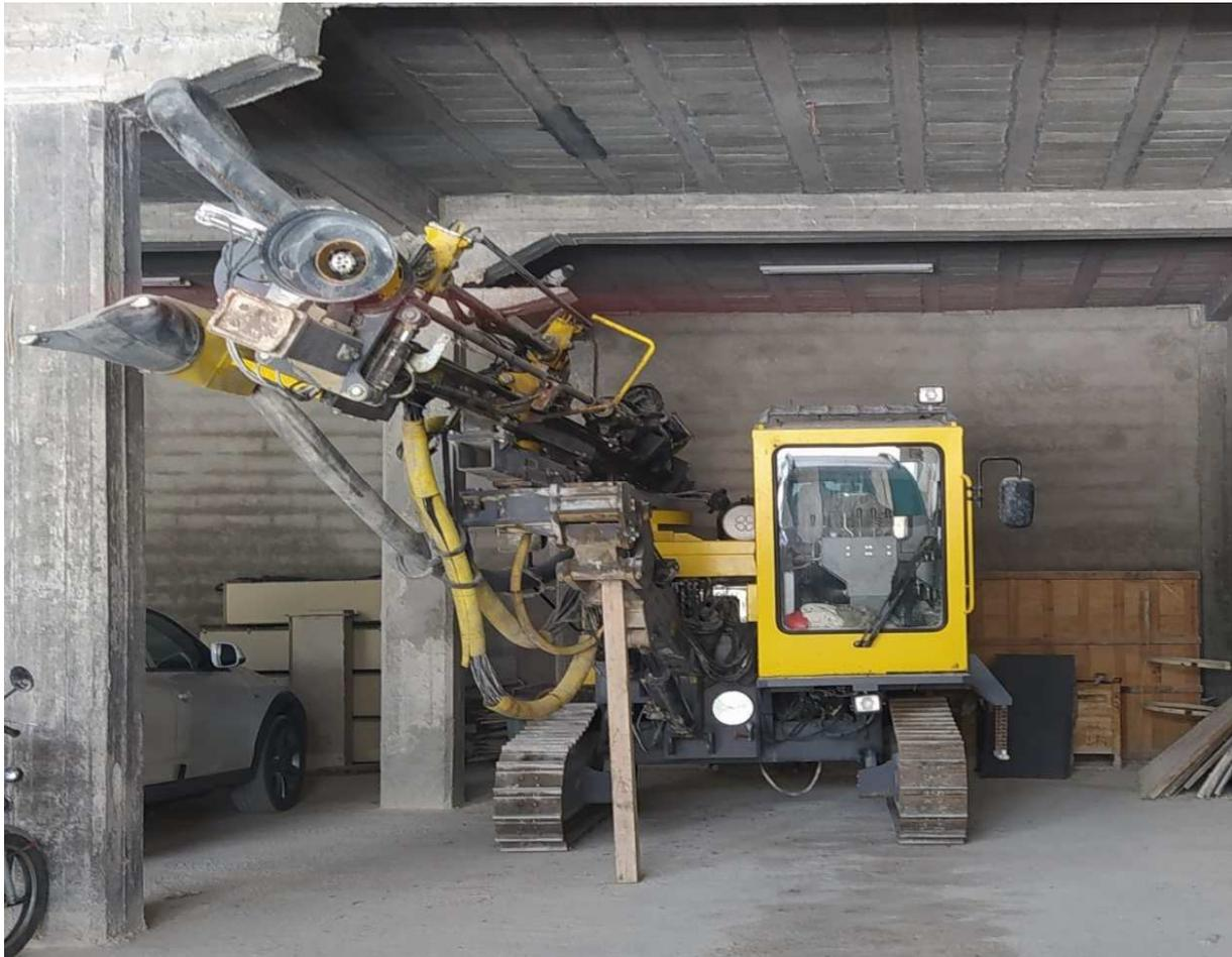
**Figure II.3** : Sondeuse principale ATLAS COPCO power Roc T 25.
