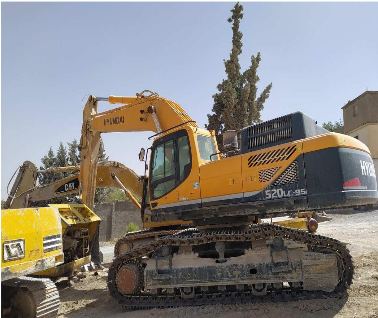
**Figure II.5 :** Pelle hydraulique utilisée pour le chargement HUYNDAI 520 LC-9S.
