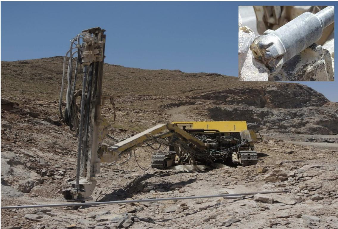
**Figure II.2** : chariot de forage BÖHLER TC 112A avec le taillant (65mm).
