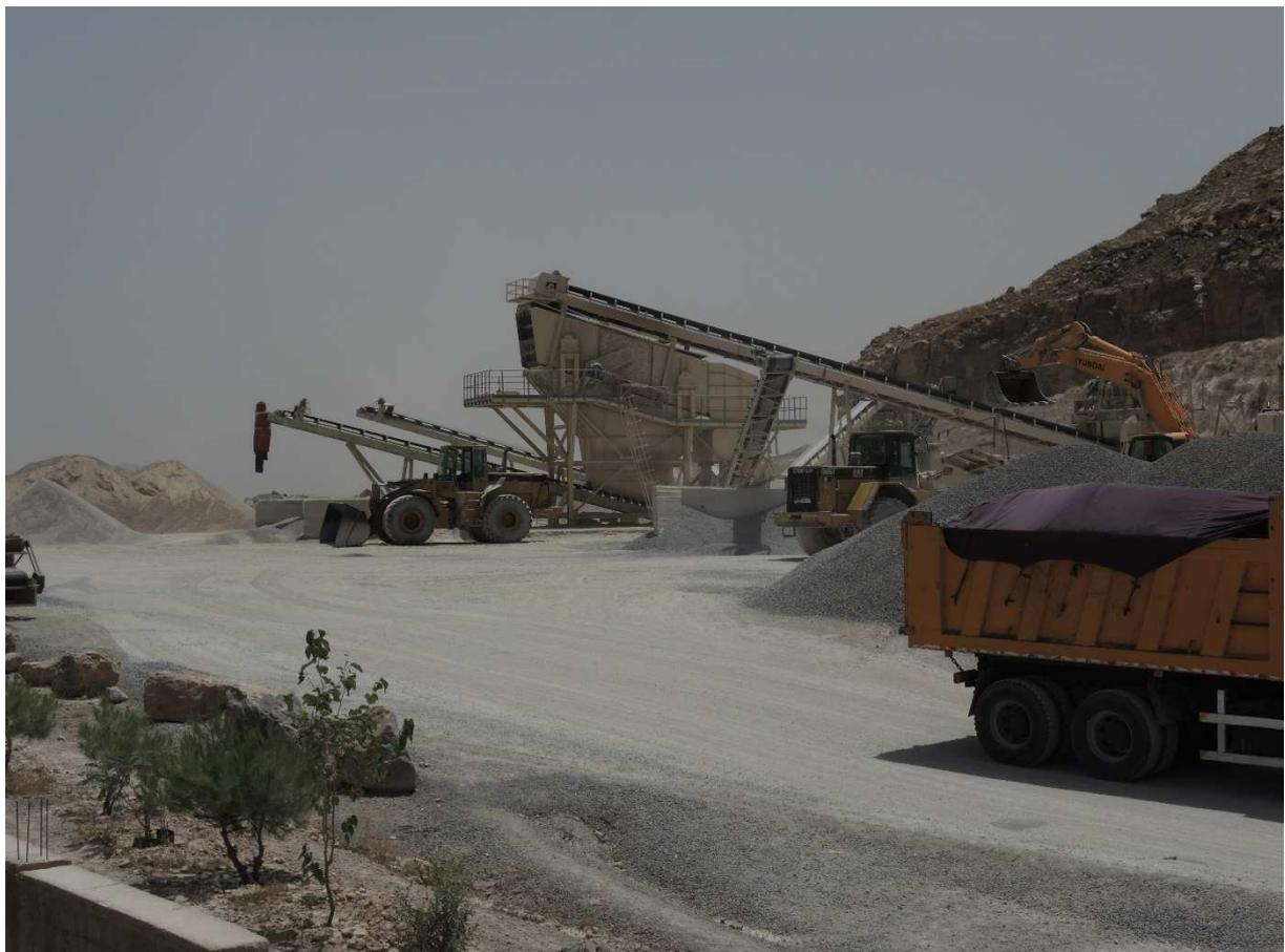
**Figure II.9** : Station de criblage et concassage.
