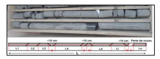
Figure 1.Illustration d'une carotte obtenue par un forage [6].
