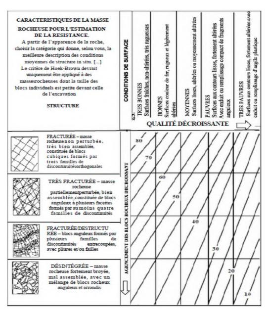
Figure 3.Estimation du GSI à partir d'une description géologique de la masse rocheuse [3]
