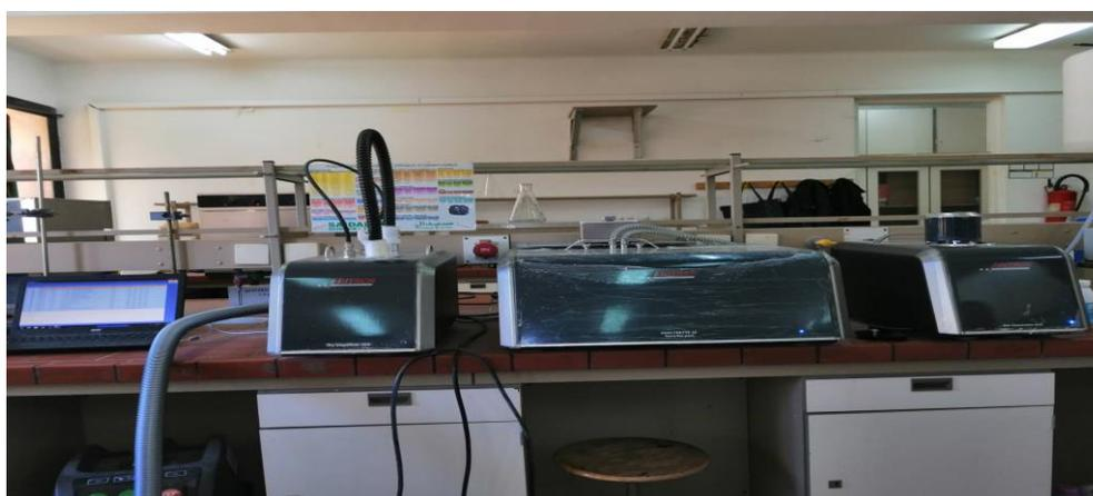
**Figure VI.7 : Granulomètre Laser**
