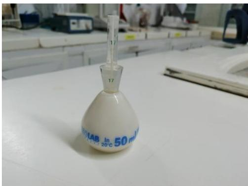
**Figure VI.5** Un pycnomètre
