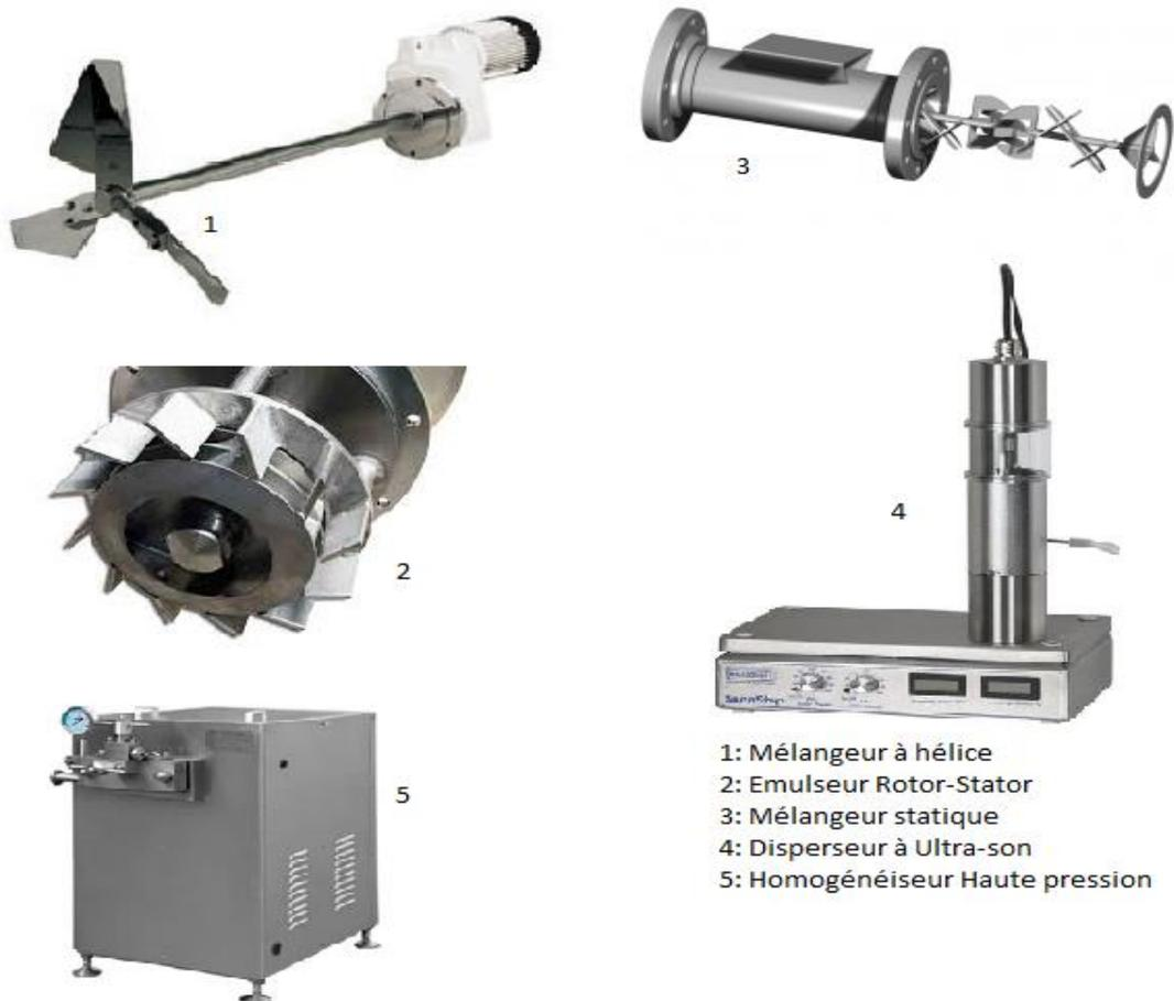
**Figure I.1 :** Quelques moyens mécaniques de dispersion.
