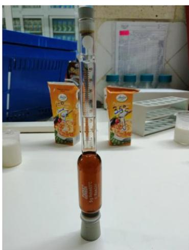
**Figure VI.3.** Un butyromètre
