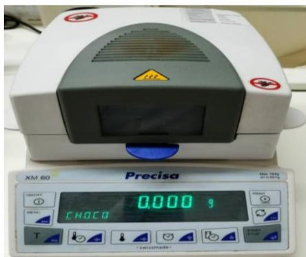
**Figure VI.2** Un dessiccateur infrarouge
