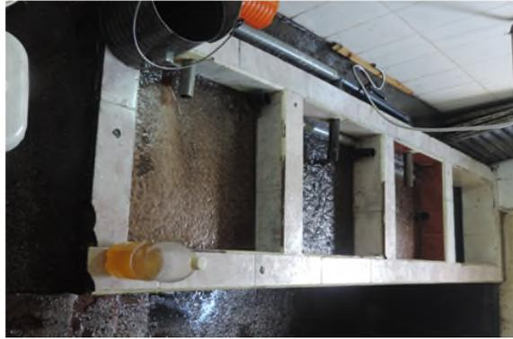
**Figure 9:** Photographie des bacs à décantation.
