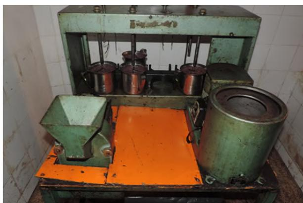
**Figure 12:** Photographie d'un Oléodoseur.
