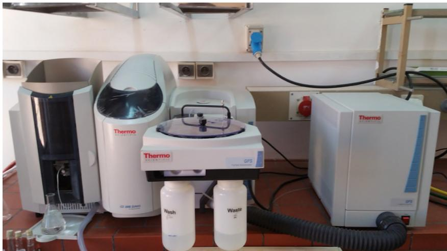
**Figure II.5 :** Photo d'un spectrophotomètre d'absorption atomique.
