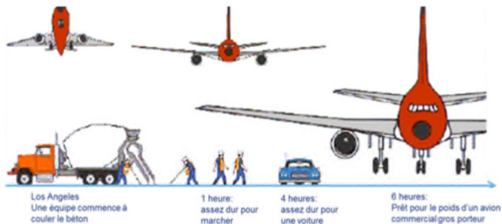
Figure I.6 Application des géopolymères dans l'élaboration du ciment Pyrament [23].
