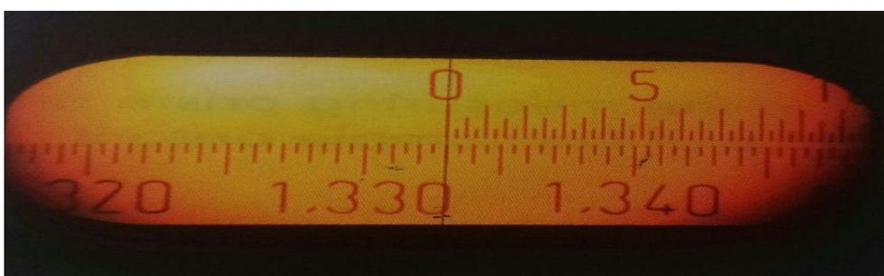
**Figure N°12** : Calibration de réfractomètre par l'eau distillée (1,3330 nD = 0% Brix).
