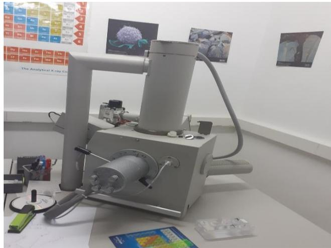
Figure II.9 : Microscope électronique à balayage(MEB)
