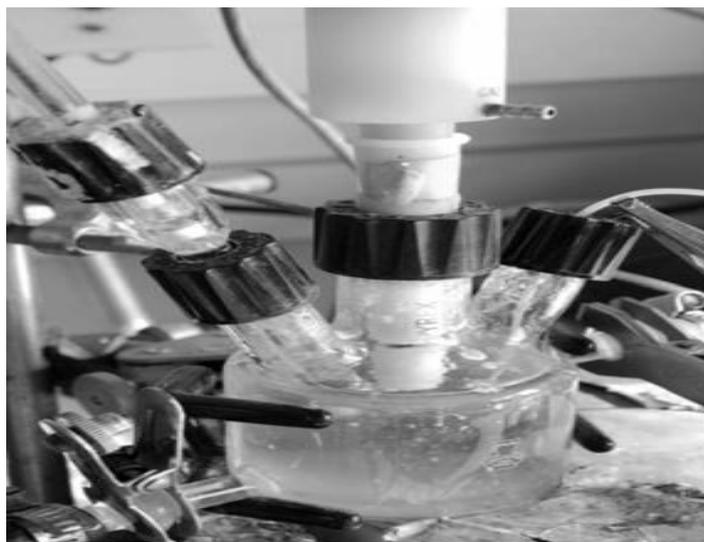
Figure II.1 : Cellule à trois électrodes
