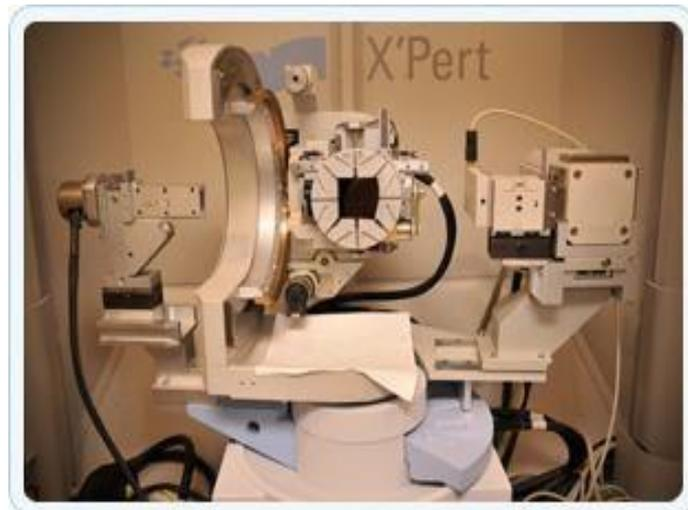
**Figure II.5** : Diffractomètre des rayons X
