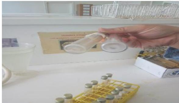
**Figure 13:** Tubes d'EVA positifs (présence des streptocoques fécaux).
