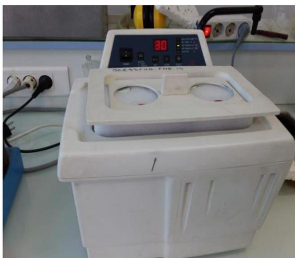
**Figure N° 06** : photo représentative du Bain à ultrasons utilisé (BRANSON).
