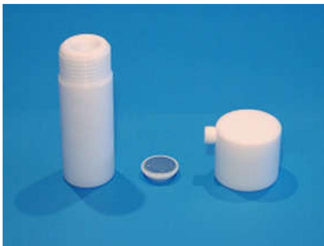
Figure II-15 : Tubes en Téflon : vessel made of TFMTM-PTEE
