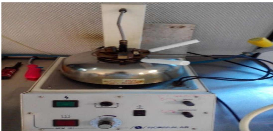
**Figure II-5 :** Appareil de PENSKY MARTENS pour la mesure du point éclair
