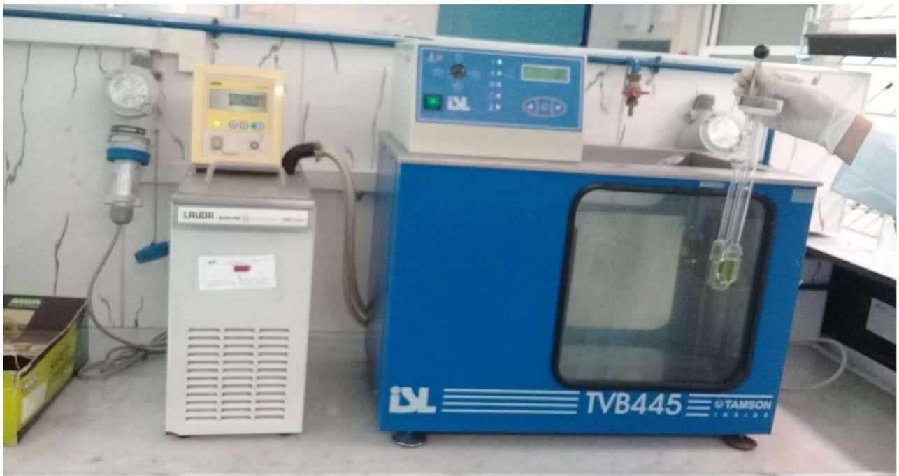
Figure II-2 : Appareillage de mesure de la viscosité Cinématique
