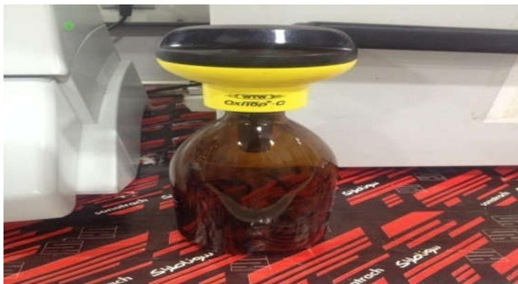
**Figure II-11** : Flacons d'échantillons en verre bruns de capacité 500 ml
