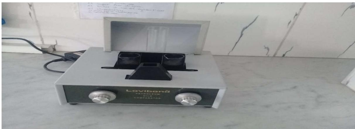
Figure II-6 : Appareillage de mesure de la couleur
