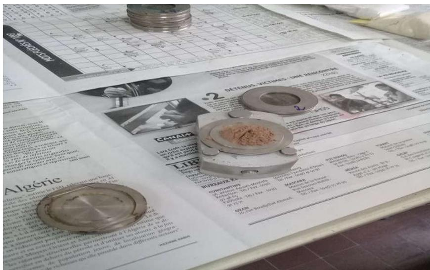
**Figure II-14:**Photo d'un porte échantillon
