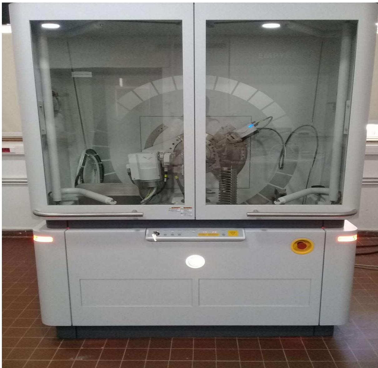
**Figure II-13:**Diffractomètre de DRX
