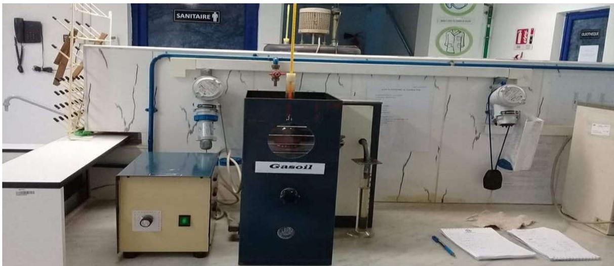
**Figure II-1 :** Appareillage de mesure de la distillation
