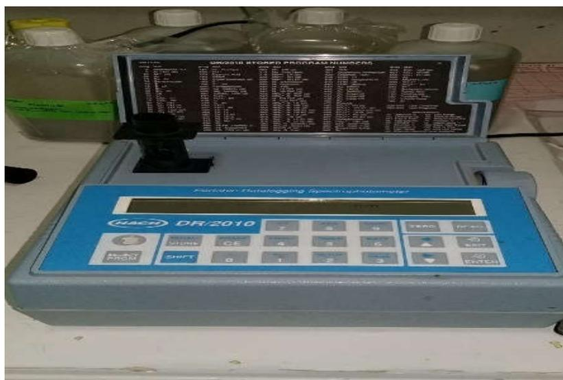
**Figure II-10** : Spectrophotomètre HACH type DR/2010
