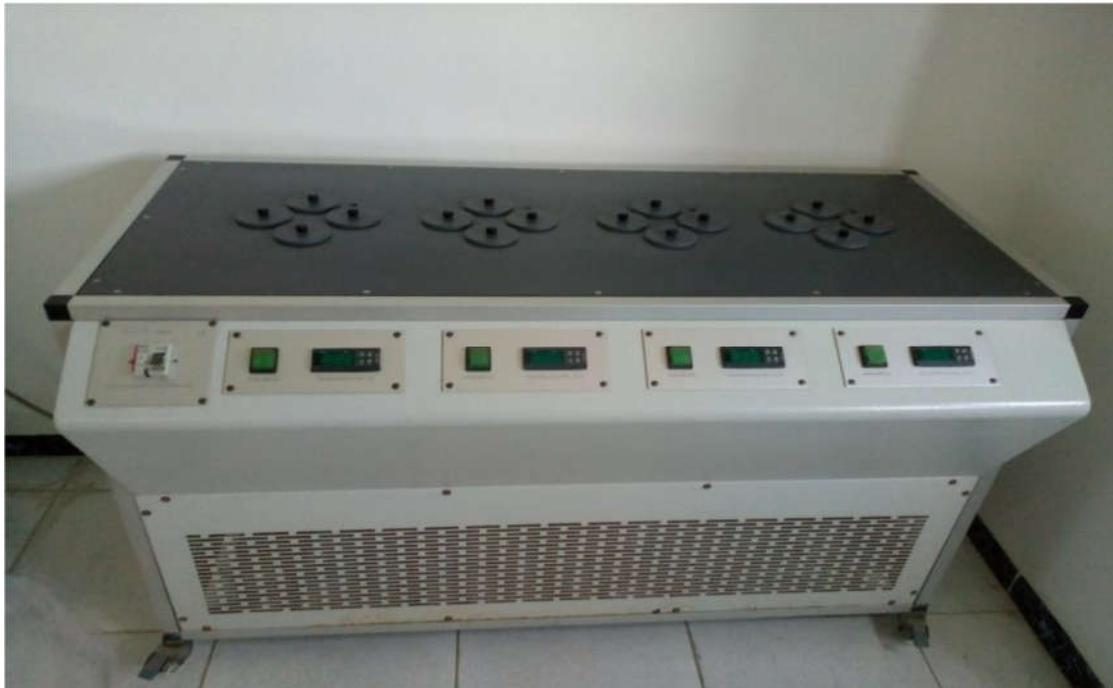
Figure II-4: Appareil de mesure du point d'écoulement
