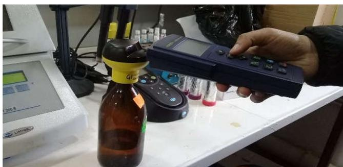
**Figure II-12:** commande de mesure de la DBO5
