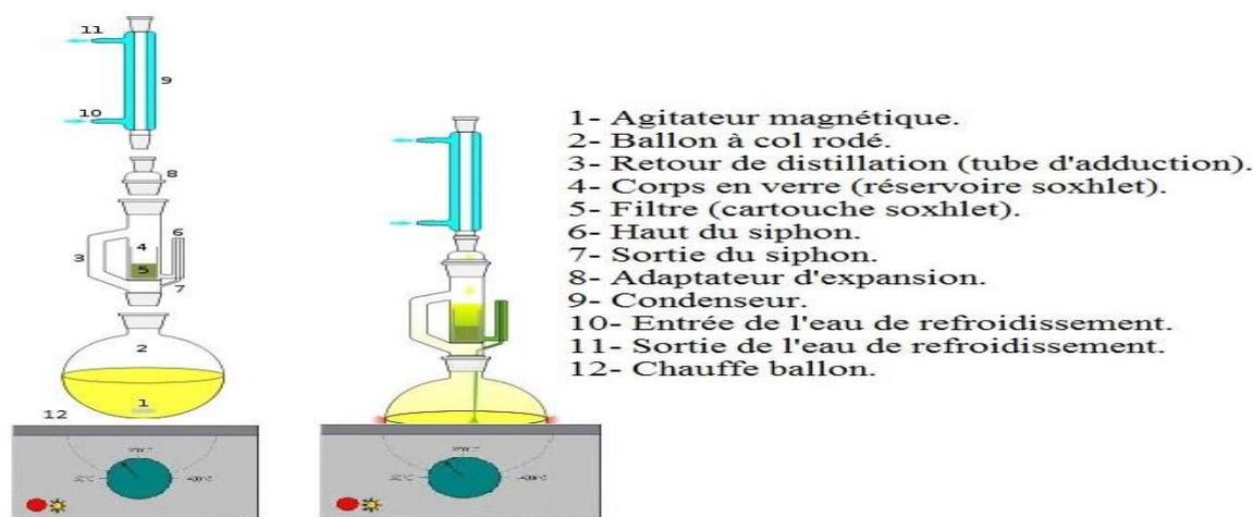
Figure II.4 : Schéma d'un montage Soxhlet [47].
