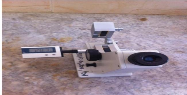
**Figure III.3 :** Un réfractomètre.
