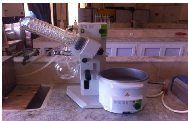
**Figure III.2 :** Dispositif d'évaporation.
