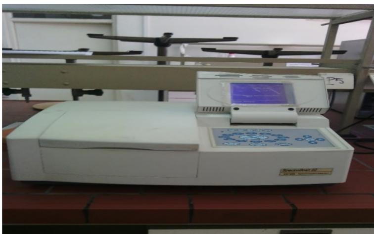
Figure II.12 : appareil de l'UV visible-spectro scan 50-
