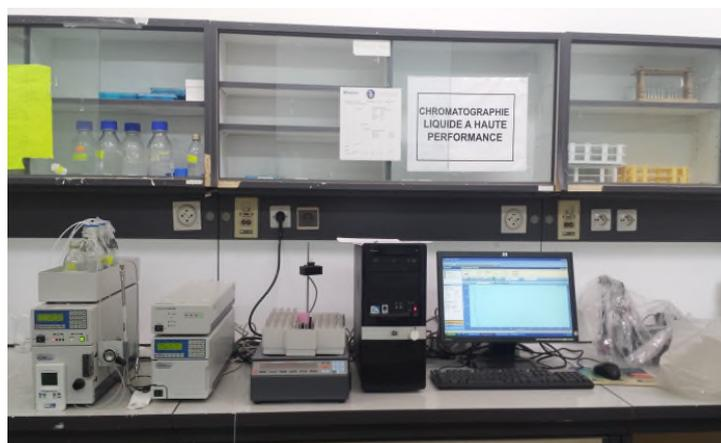
**Figure II.10** : montage de l'appareil HPLC
