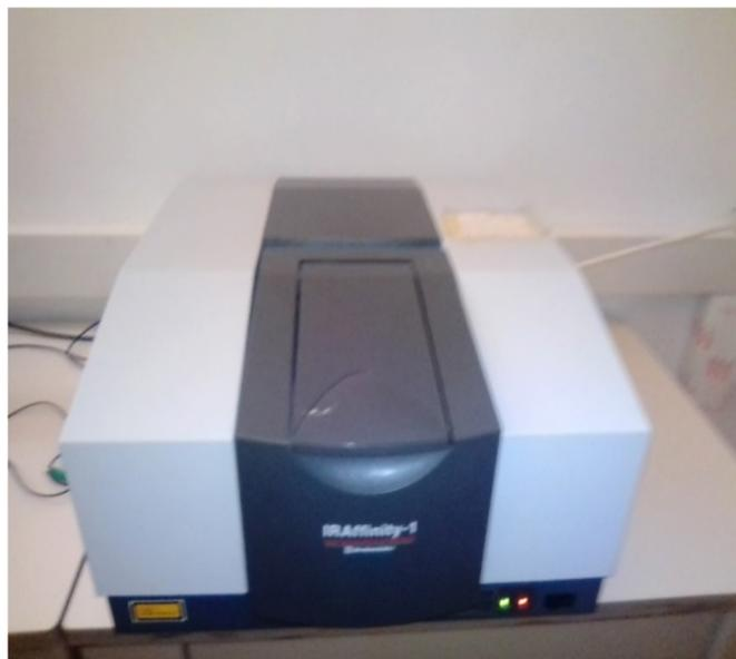
**Figure II.11** : appareil de l'Infra Rouge- shimadzu-
