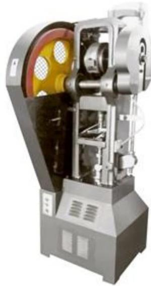
**Figure II.6 :** Machine à comprimé alternative [21]
