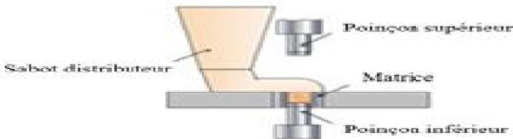
**Figure II.10** : Schéma des étapes de compression : remplissage
