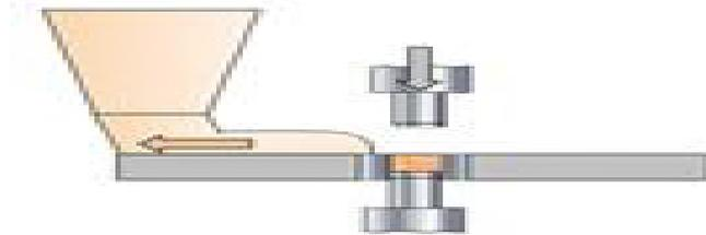
**Figure II.11 :** Schéma des étapes de compression : arasage
