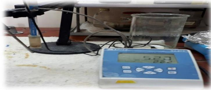
**Figure N°7 :** Appareil de pH mètre
