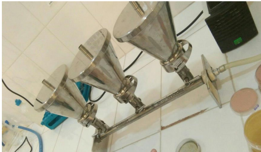
Figure 09 : Rampe de filtration pour les analyses bactériologiques (Laboratoire de l’ADE).
