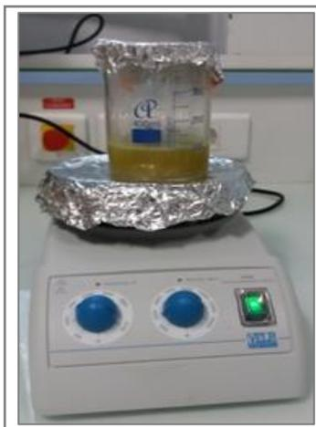
**Figure 10.** Extraction conventionnelle des CPT sur plaque agitatrice
