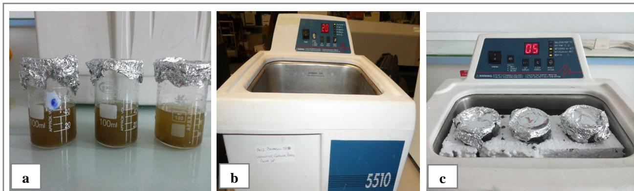
**Figure 11.** Extraction aux Ultrasons des CPT : a) Mise en contact poudre de cladode-solvant (trois tests), b) Bain à Ultrasons, c) Les trois béchers placés en Bain à Ultrasons.
