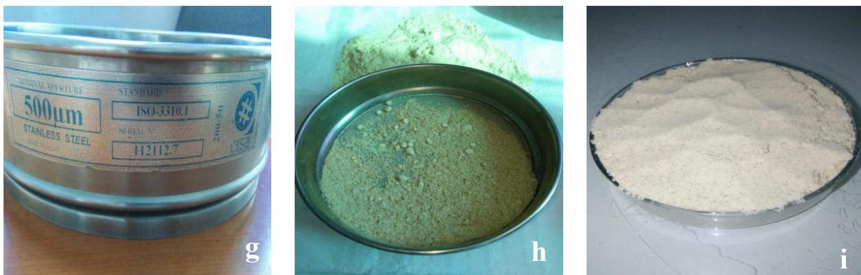
**Figure 13 (i, g et f) : Tamiseur (g), refus de poudre tamisée (h) et la poudre après tamissage (i)**
