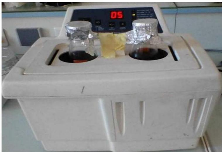
**Figure 15 :** Appareil ultrasons à bain utilisé pour l'extraction (Cliché Boussekine et Agoune, 2020)
