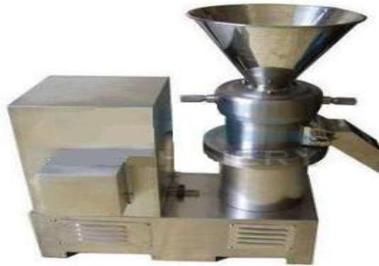
**Figure 8** : Moulin à meule métallique (Knoden *et al.*, 2011).
