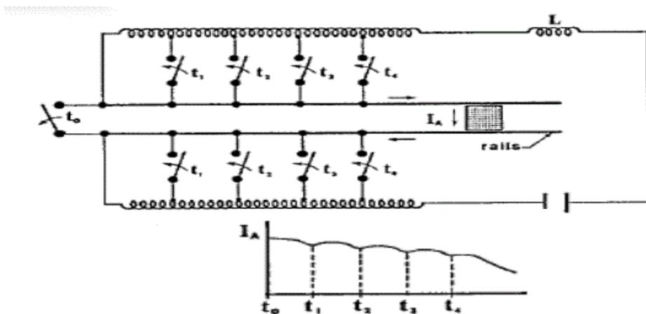
Figure II. 5- Décharge de multiple courant
